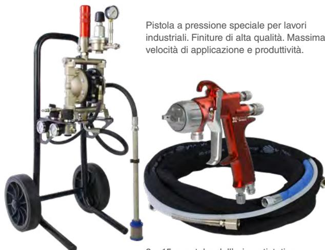
8 x 15 mm. tubo dell'aria antistatico e 6 x 8 mm. tubo prodotto con copertura in Nylon. Tubo leggero e resistente
