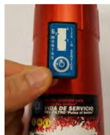
Quando inizi a utilizzare il filtro devi premere il pulsant "ON" sul dispositivo.
