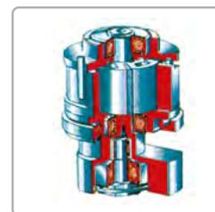
Giranti e rotore in materiale composito. Esente da lubrificazione, funziona senza olio. Sistema di contrappesi per garantire un funzionamento regolare.
